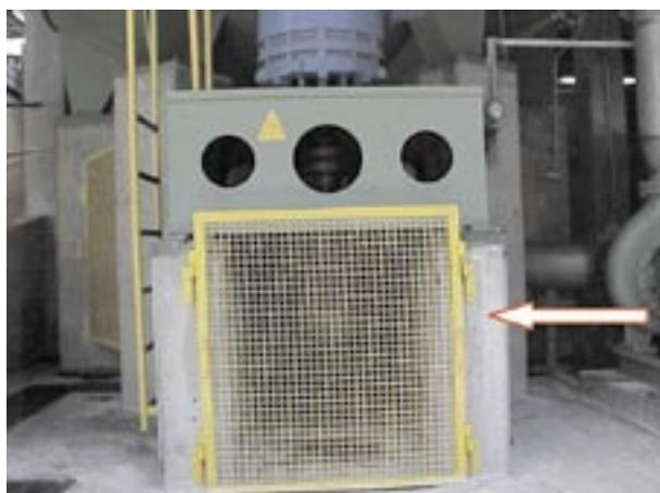
**Foto 7-B:** Motor elétrico de acionamento do hidrapuper DEPOIS :
